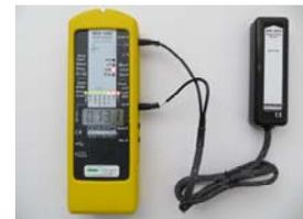
Um die Sonde in Betrieb zu nehmen, nach dem Anschließen einmal kurz die Taste „rec.“ drücken. Auf dem Display wird die magnetische Flussdichte in der Einheit  $\mu\text{T}$  (=1000nT) angezeigt, das heißt, die LEDs „nT“ und „x1000“ leuchten rot. Die LEDs am Sensor beginnen zu leuchten.
